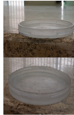
شکل (۱): پتری‌دیش طراحی شده. بالا: کفه کوچکتر، پایین: درب با حلقه آب‌بند
